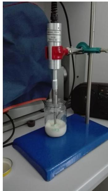
Slika 6- Ekstrakt tla sa nanočesticama ZnO u ultrazvučnoj kupelji
