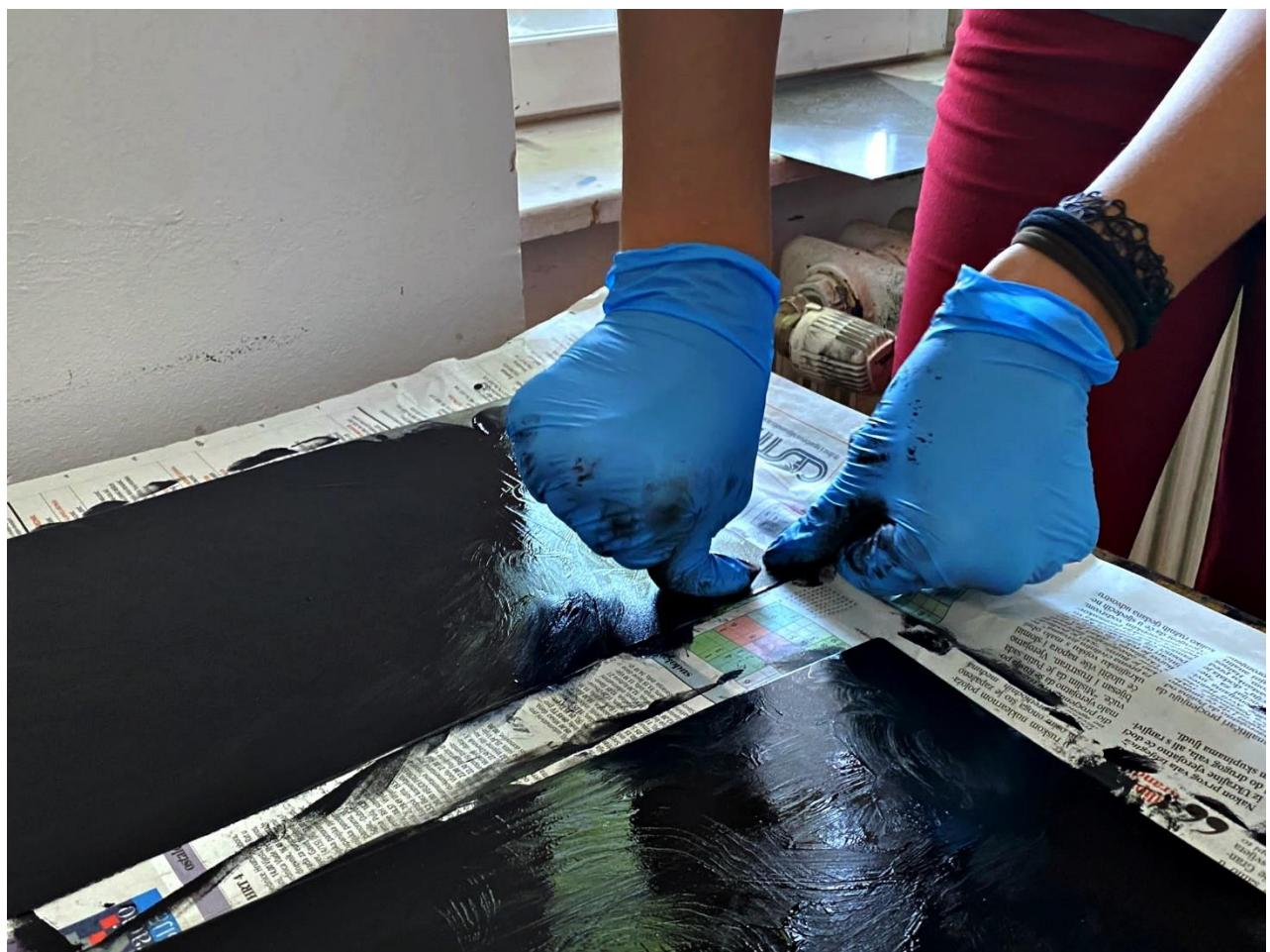
Slika 17. Nanošenje tiskovne boje na ploče
